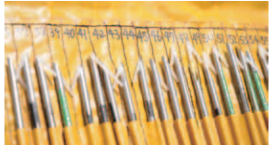
(上)標識は先が針状になっていて、ストロー状の金属の筒に入れて装着する。 (右)記録型標識(アーカイバルタグ)は、カツオの回遊中の位置が推定できるほか、水温や水深などが記録される。
