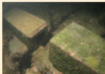
通常のコンクリート（左奥）に対して藻類の生長が顕著な環境活性コンクリート（右手前）
