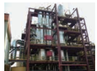
ブラジル・バルバライソ工場のMVR。5工場合計で、導入前に比べ年間約5万トンのCO 2 を削減。
